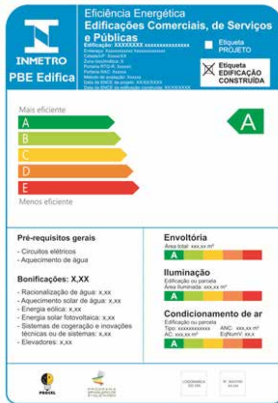
Etiqueta do Inmetro que certifica a eficiência energética em edificações comerciais, de serviços e públicas
