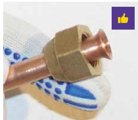
**Imagem 55:** Flangeamento profissional com porca (flange) de conexão.
