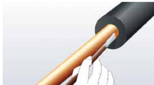
**Imagem 65:** Colagem da extremidade do isolamento com o tubo de cobre (espessura mínima da parede do material de isolamento).
