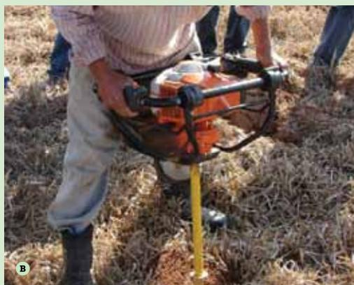
**Figura 6.25:** Aspecto de uma motocoveadora (A) e abertura de cova com motocoveadora (B).
