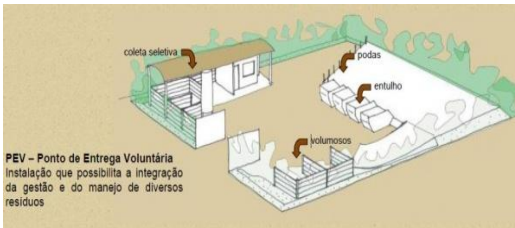
Figura 5. Ponto de Entrega Voluntária (PEV) que integra a função de concentração de cargas para a coleta seletiva
