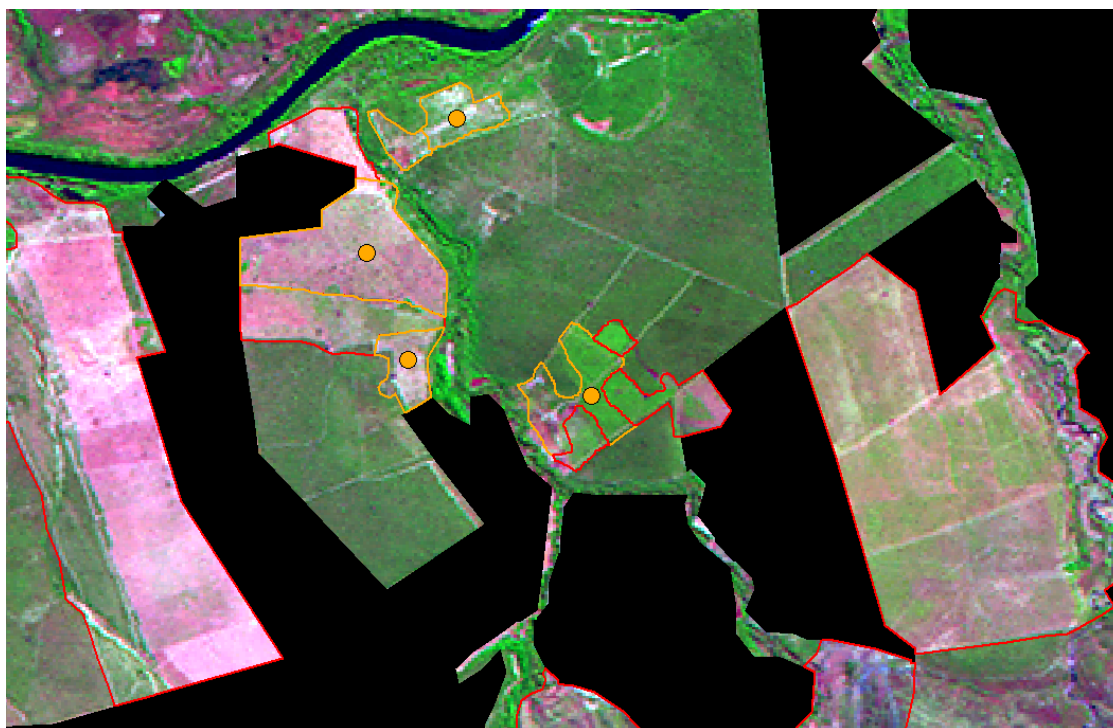
Figura 2.6. Estágio final: a) mesma imagem de 2008, contendo os polígonos pretos referentes ao desmatamento de 2002 (máscara PROBIO); b) em vermelho, o desmatamento de 2009 detectado pelo intérprete do IBAMA, conforme Figura 2.3; c) círculos laranja, destacando que naquelas áreas já existiam desmatamento em 2008; e d) polígonos de borda laranja, indicando o ajuste feito pelo intérprete.
