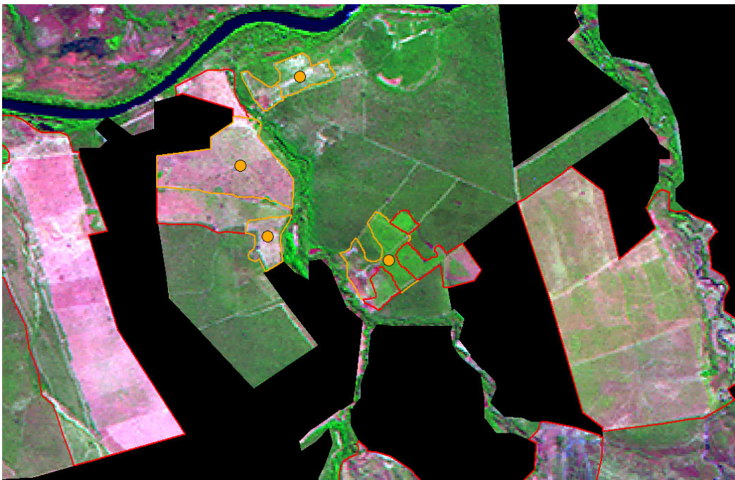
Figura 2.6. Estágio final: a) imagem de 2008, contendo os polígonos pretos referentes ao desmatamento de 2002 (máscara PROBIO); b) em vermelho, o desmatamento de 2008, detectado pelo intérprete do MMA/Ibama, conforme figura 2.3, e; c) círculos laranja, destacando que naquelas áreas já existiam desmatamento em 2002, com seus respectivos polígonos de bordas laranjas, indicando, assim, o ajuste feito pelo intérprete.
