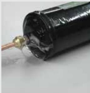
Teste de bolhas de água e sabão e indicação de vazamento em conexão mecânica. Antes de aplicar a solução de sabão, o fluido refrigerante foi recolhido e o sistema foi pressurizado com OFDN com cerca de 10 bar.
