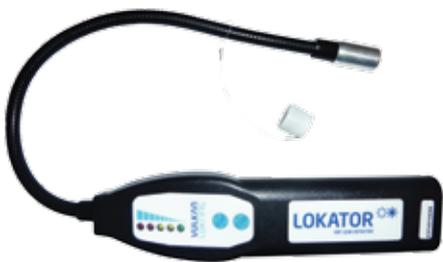
**Figura 4.7:** Detector de gás para uso múltiplo de refrigeração, incluindo os hidrocarbonetos.
