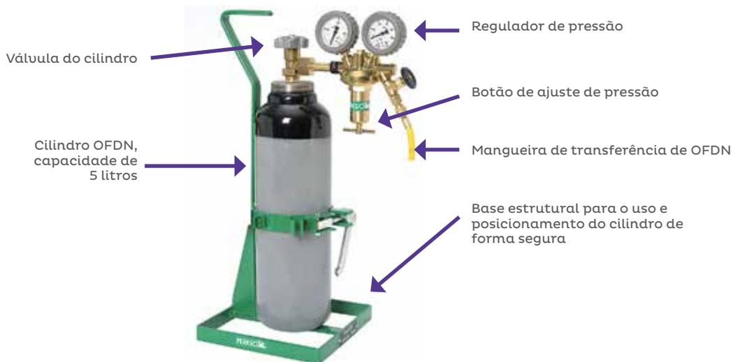
**Figura 3.5:** Exemplo de um conjunto de cilindro de OFDN.
